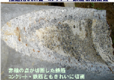
推進用50N管 コンクリート・鉄筋切断断面
